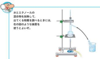
水とエタノールの混合物を加熱して、出てくる物質を調べるときには、右の図のような装置を使うとよい。
