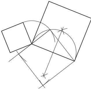
⇒ 三平方の定理、すなわち、「直角三角形の直角をはさむ2辺の長さをそれぞれ1辺とする正方形の面積の和は、斜辺を1辺とする正方形の面積の和に等しい」ことを利用して、次の①～④の手順で作図する。
