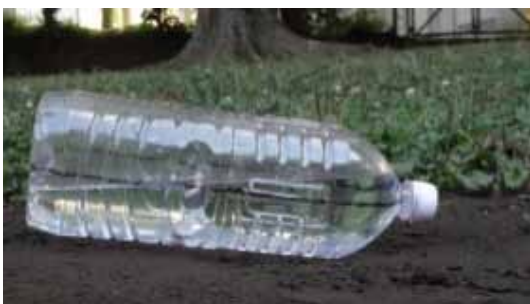
第3・4次で活用する測定器 地面の傾きを客観的に捉えられるようにした。
