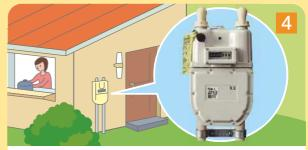
4 家庭などに取り付けられているガスメーターは、 震度5程度の大きな地震でガスを自動的に止め ます。ガス管などに被害がなければ、各家庭でガ スを使えるようにもどすことができます。
