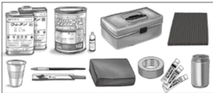
ウレタン注型剤・シリコン(模型店などで入手可能)、型取り用ボックス(100円ショップなどで化石の大きさにあったものを購入)、ダンプレート(ホームセンターなどで入手可能)、計量カップ(ウレタンが使える専用のもの。そうでないものは溶けてしまう危険がある)
