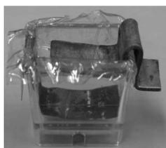
図5 ダニエル電池の組み立て
