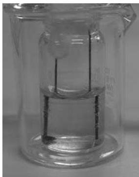
図3 マイクロスケール電気分解の例
