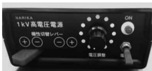
図11 電源装置 1000 Vの電圧で実験を行うことができる。
