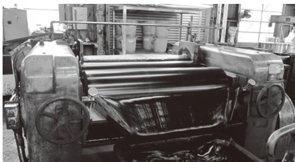
それぞれの製品に適した粒子の大きさに分散させるため、ロール掛けをしている様子。
