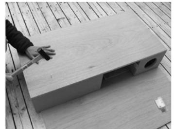
反対側の側板を貼り付けます。音道は部品が上からぶら下がる構造なので、その補強を狙って何箇所かに釘を打ちました。
