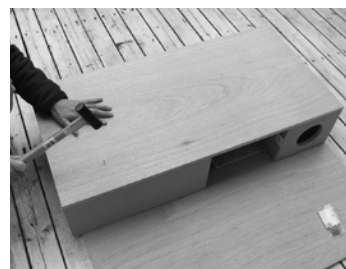
反対側の側板を貼り付けます。音道は部品が上からぶら下がる構造なので、その補強を狙って何箇所かに釘を打ちました。
