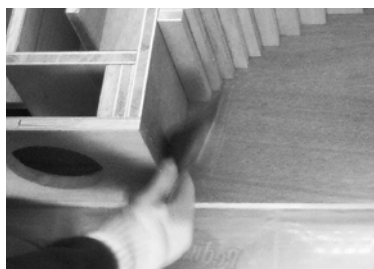
組み立てていくうちに、各部品の誤差により、角が合わなかったり、隙間が空いてしまっているところがありました。そこをヤスリで削って調整しました。
