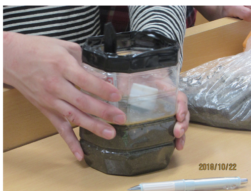
図1 液状化現象の実験に用いた手作り器具
